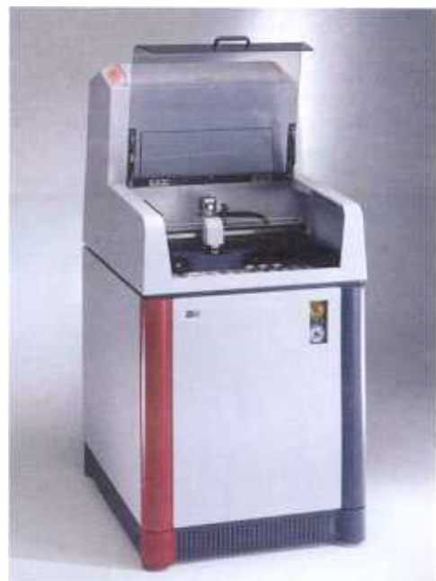
Figura 5: difractómetro moderno sirviendo la determinación de fases cristalinas (D4 ENDEAVOR)
