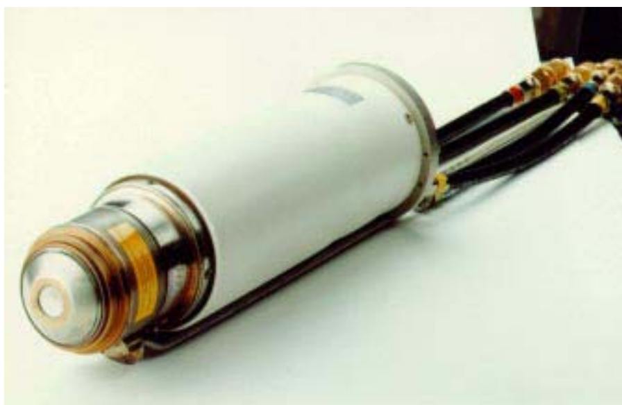
Fig. 3 Los tubos de rayos X con acoplamiento óptico muy cercano y ventana de berilio ultrafina optimizan el análisis de los elementos ligeros (tubo de rayos X de ventana frontal Siemens AG Rh 66 G)
