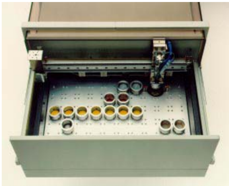
Fig. 4 Cambiamuestras grandes facilitan una capacidad máxima de medidas (cambiamuestras del SRS 3000 manejando hasta 100 muestras sin portamuestras)
